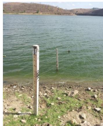
Foto 02: Conjunto de réguas linimétricas.
