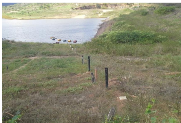
Foto 02: Conjunto de régulas linimétricas.
