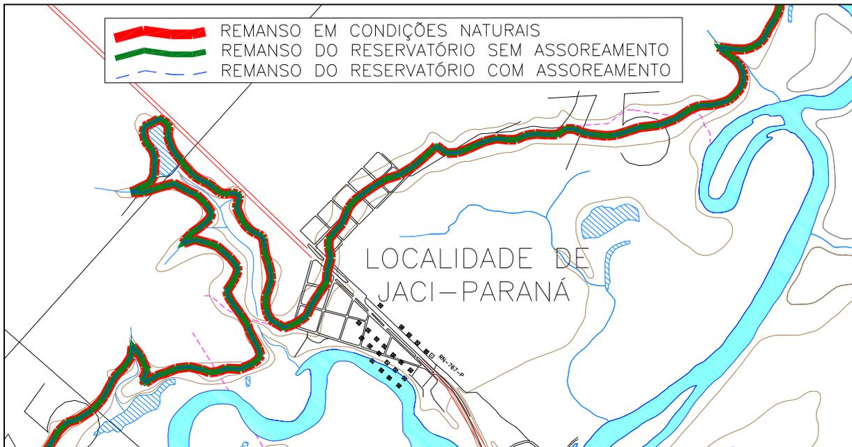
Figura 27 – Contornos de inundação na localidade de Jaci-Paraná, para a vazão com TR 50 anos, considerando os efeitos do assoreamento sobre o remanso
