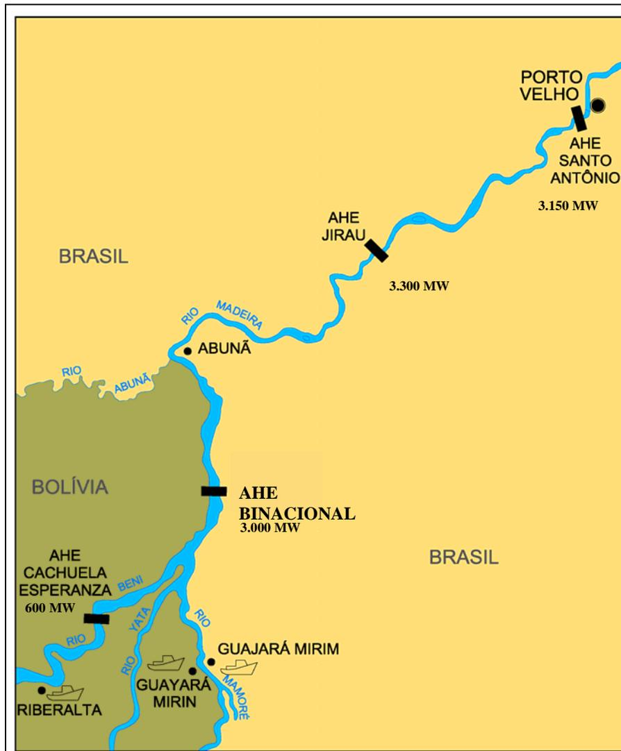
Figura 5 – Complexo hidrelétrico do rio Madeira. (Fonte: EVI).
