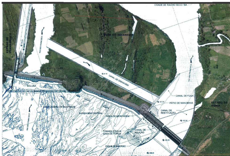
FIGURA 12 – ARRANJO DA ECLUSA E CANAL DE NAVEGAÇÃO PELA MARGEM ESQUERDA
