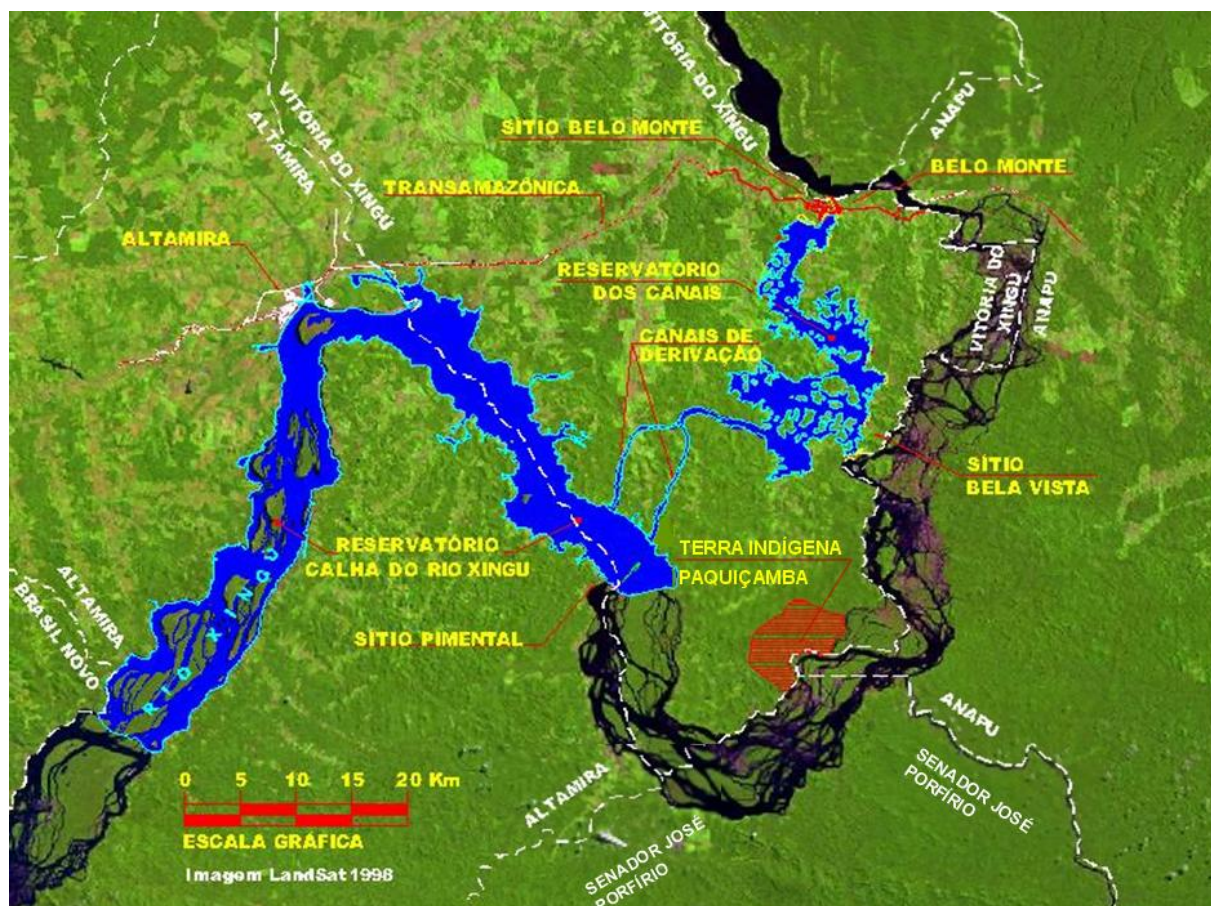
FIGURA 6 – ARRANJO GERAL DO AHE BELO MONTE. (FONTE: EVI).
